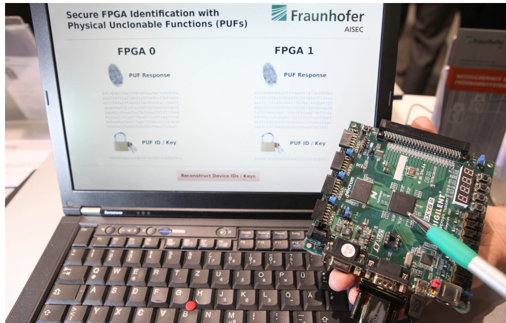
Abbildung 2.4: Verwendung von Physical Unclonable Functions zur Generierung von geheimen Schlüsseln
